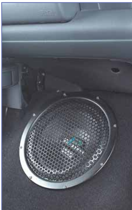
Der Woofer im Fußraum nimmt keinen Platz weg, da er einen original vorhandenen Styrodurkeil ersetzt
