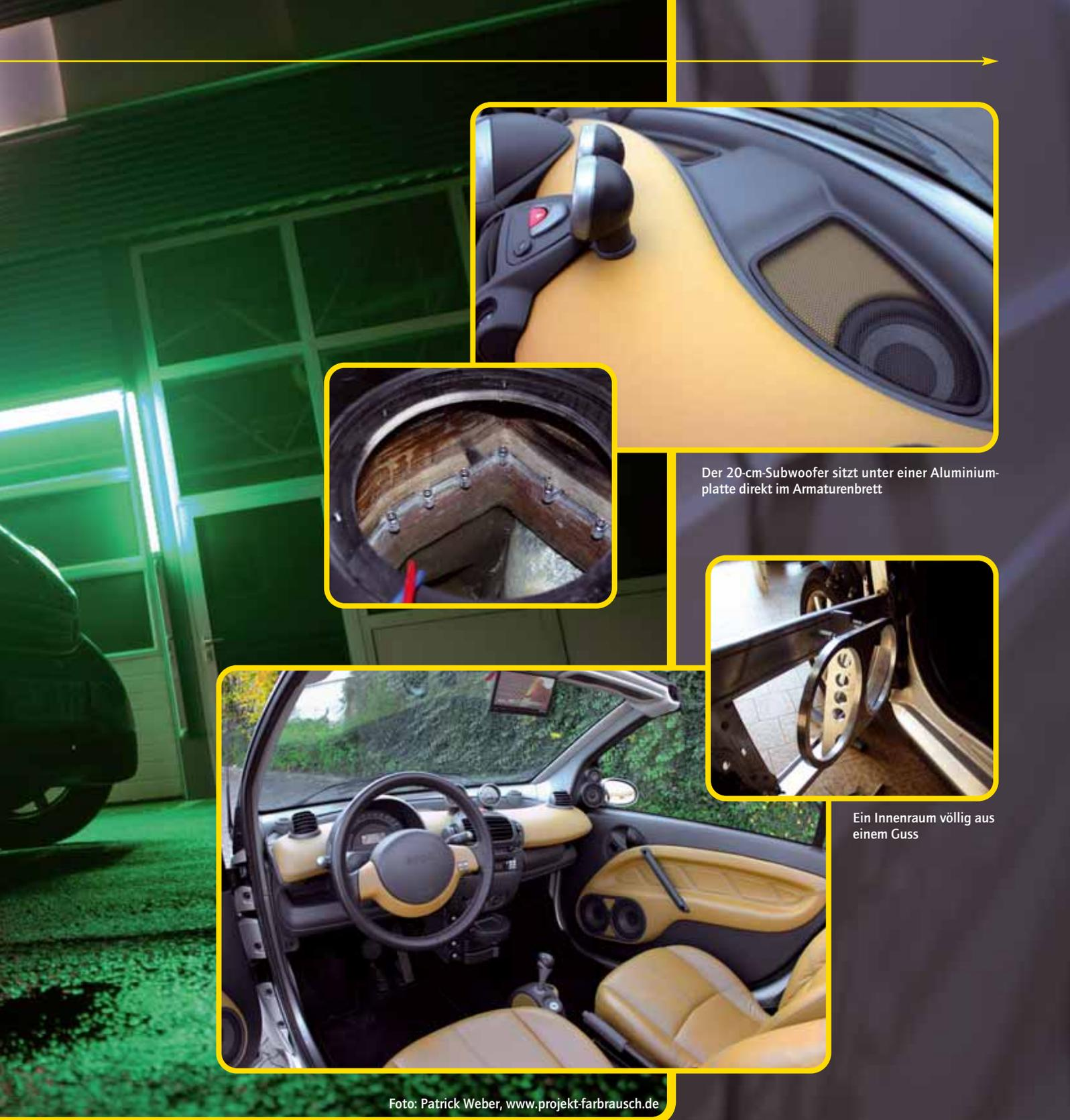
Der 20-cm-Subwoofer sitzt unter einer Aluminiumplatte direkt im Armaturenbrett
