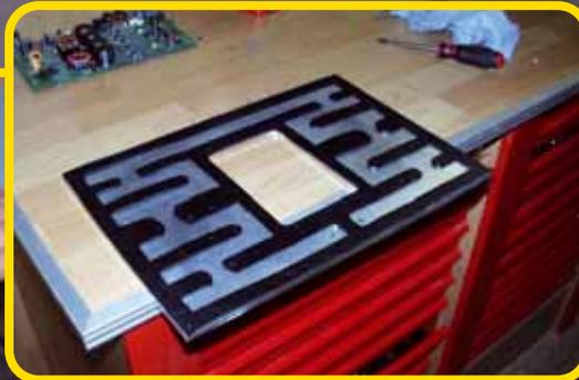
Die Kühlflüssigkeit für die Endstufen durchläuft diese Kanäle und sorgt so großflächig für die Temperaturregulierung
