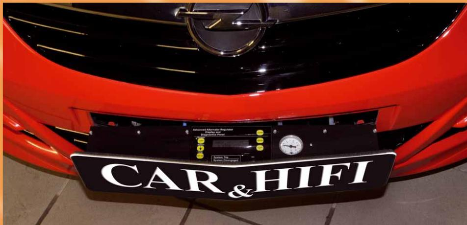
Ebenfalls pneumatisch fährt die Serviceeinheit für Kennlinienladegeräte, Druckluftanzeige und SF6-Anschluss hinter dem Nummernschild heraus
