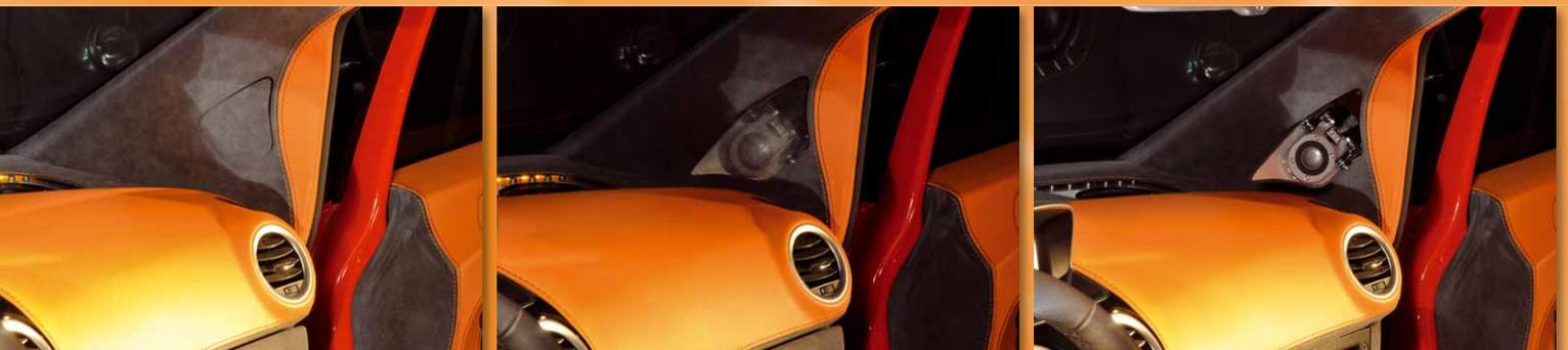
Die Berylliumhochtöner klappen pneumatisch angetrieben aus den A-Säulen und sind ebenfalls ausrichtbar
